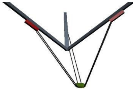
图2.12 三脚架 Delta 机器人机械结构示意图
